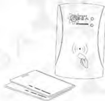
BOTOEIRA DE ACESSO VIA CARTÃO PARA CONTROLE DE ACESSO.
